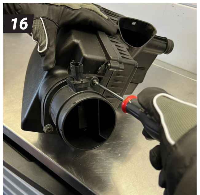
16 Demontera luftmassemätaren från originalets luftbox.
