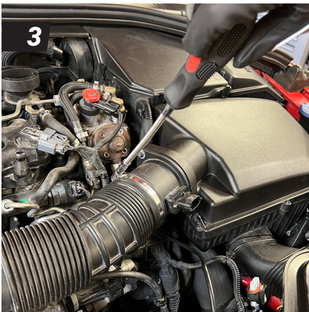
3 Lossa slangklämman på luftslangen.
