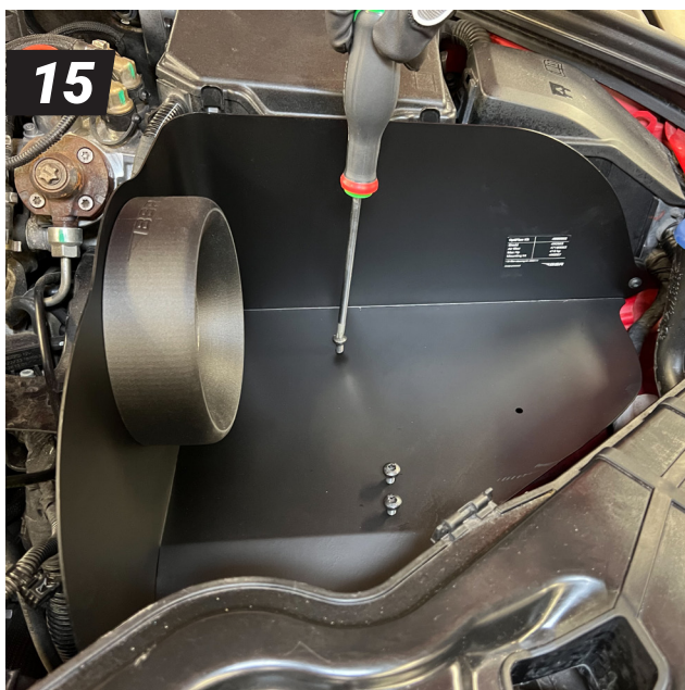
15 Montera avskärmningsplåten (1) i bilen med skruvarna (9). Se till att få i alla skruvarna innan åtdragning.
