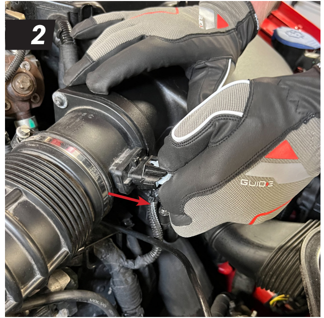
2 Lossa kontakten på luftmassemätaren.
