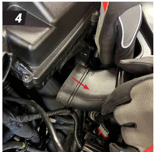
4 Demontera kallluftsintaget mellan luftboxen och fronten på bilen.
