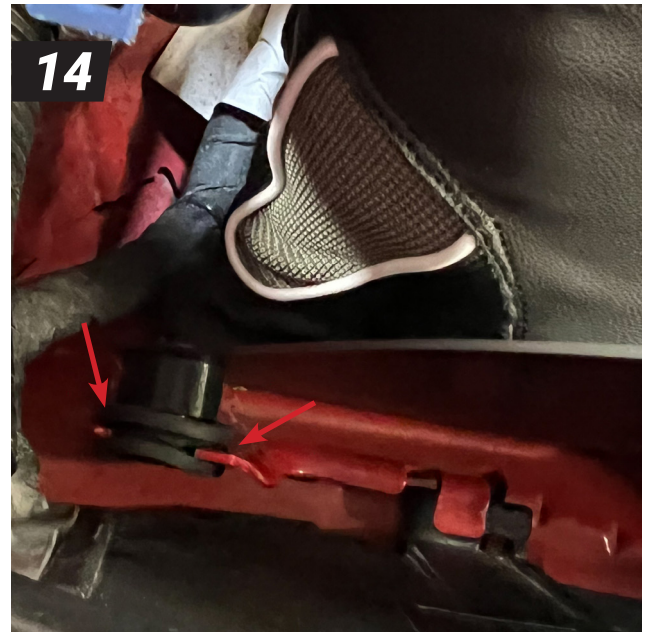
14 Lyft i avskärmningsplåten (1) och tryck i gummiringen i sitt fäste i karossen.
