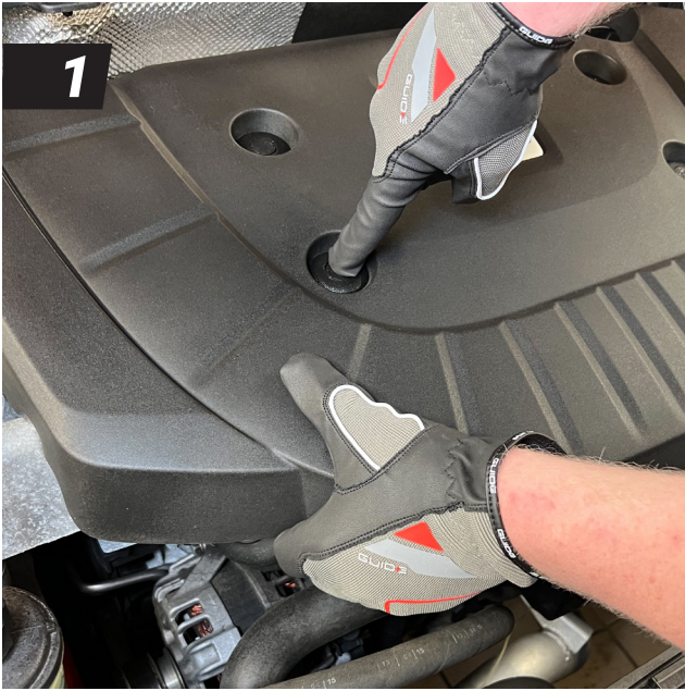
1 Demontera motorkåpan genom att trycka ner i mitten på fästena och lyfta i kanten på kåpan.
